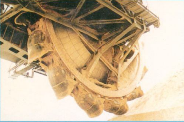
Bagger kazıcı VAUTID-143 aşınma plakalarından imal döküş şutu astarı
