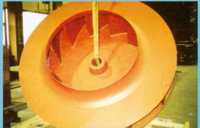
Ağaç veya çimento endüstrisinde kullanılan fan rotoru VAUTID-143'den imal
