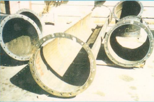
VAUTID-100'den imal konveyör boruları
