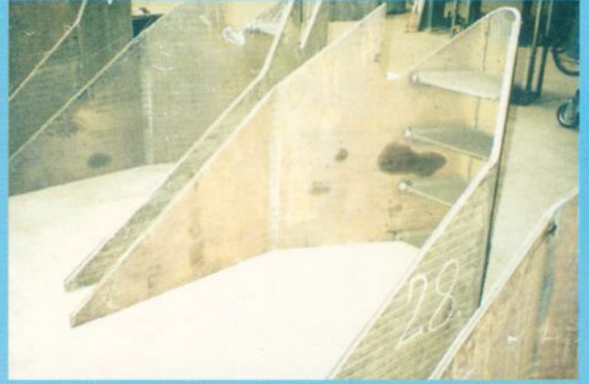
VAUTID-100 T'den imal edilmiş gaz soğutma sistemi agrega korumaları
