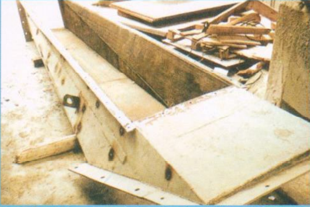
VAUTID-100 aşınma plakasından imal edilmiş klinker akış şutu
