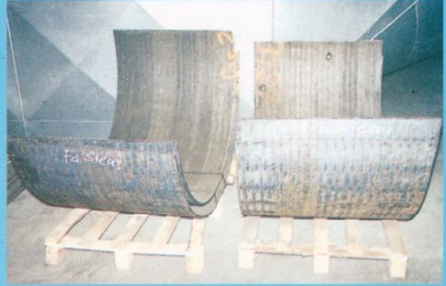
Dik değirmen astar plakaları olarak kullanılmak üzere bükülmüş VAUTID-100 aşınma plakaları
