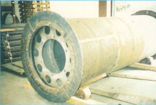
VAUTID-100'den imal edilmiş sinter besleme tamburu. d= 1300 mm, l=3200 mm
