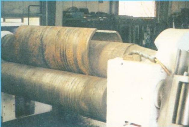
VAUTID aşınma plakalarının bükümü
