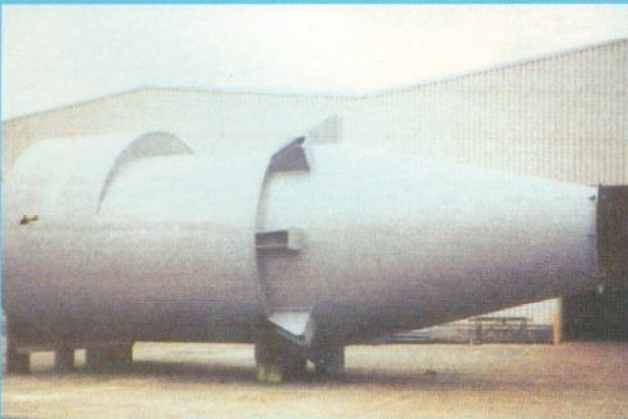
Komple VAUTID- 100'den imal üst prekalsinasyon siklonu
