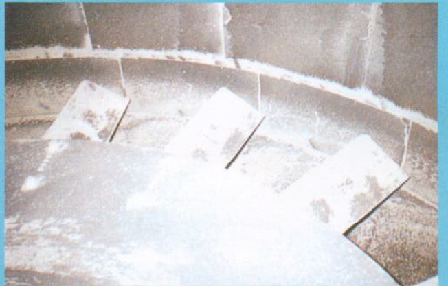
VAUTID-100'den imal edilmiş döner tabla sıyırıcı kanatları
