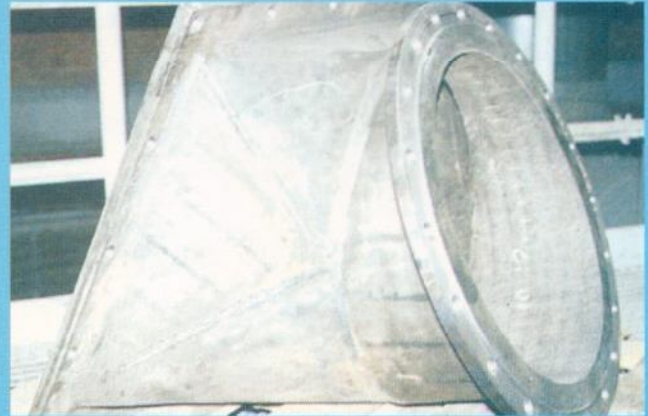
Kömür tozu dağıtım kanalı VAUTID-200'den imal
