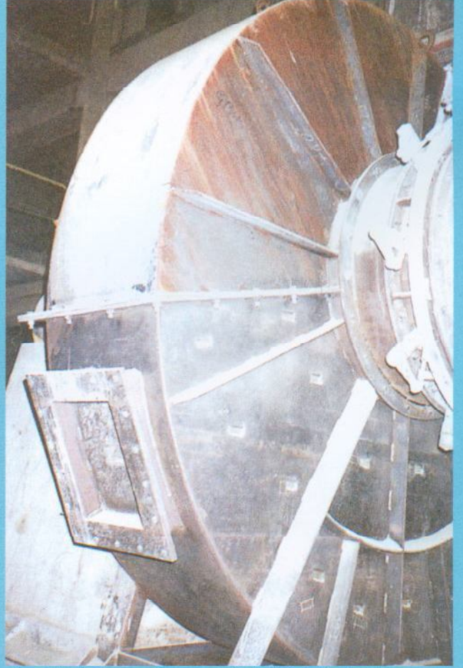
Fan gövdesine açılan montaj delikleri ile içeriye monte edilen VAUTID-145 aşınma plakalarından imal edilmiş fan astarı
