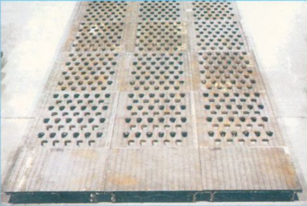
VAUTID-100'den imal edilmiş soğuk sinter elek plakası
