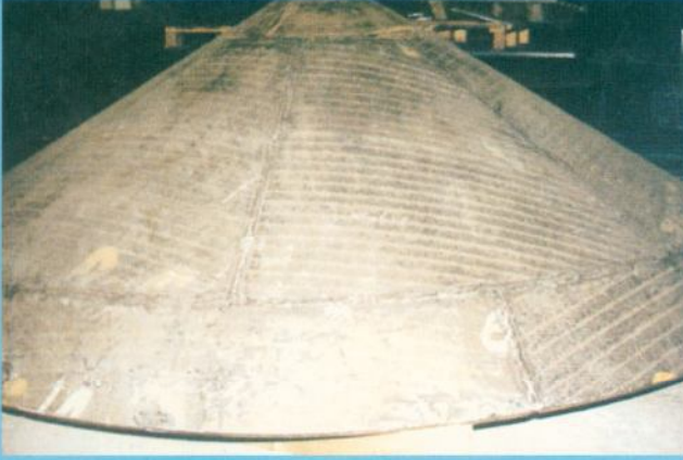
VAUTID-100 K'dan imal edilmiş gaz soğutma kulesi kok dağıtım konisi
