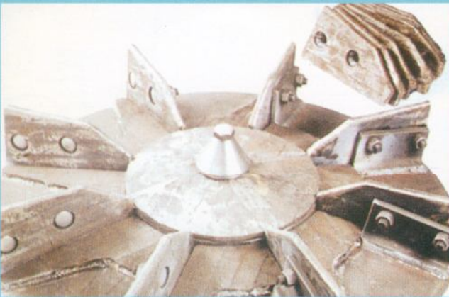
Ağaç endüstrisinde kullanılan nakil fanı rotoru VAUTID-100'den imal
