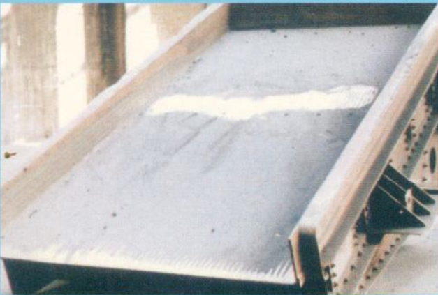
VAUTID-100'den imal edilmiş vibrasyonlu şut
