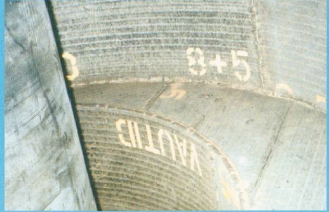
Daha sonra birleşim bölgeleri elektrodlarla sert dolgu işlemine tabi tutulmuş VAUTID-100 aşınma plakalarından imal edilmiş siklon iç astarı
