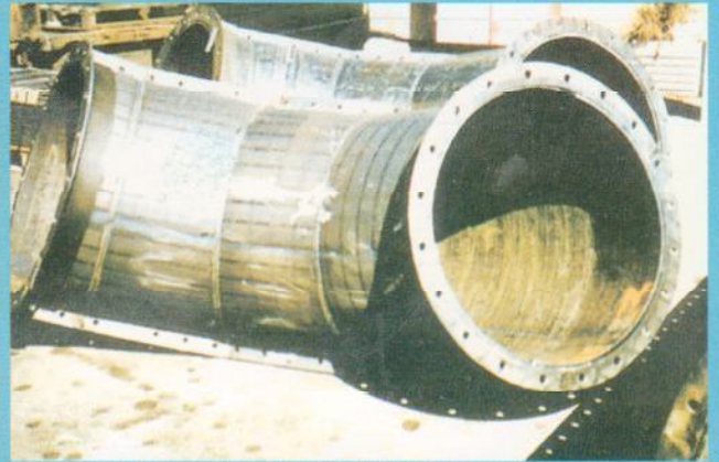
VAUTID-143'den imal edilmiş dirsekler
